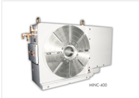
电脑数控分度盘的正常使用和维护注意事项（三）分度盘是各类铣床的主要附件是不可缺少的工具，它能将装在顶针之间或卡盘上的工件分成任意角度或等分，可进行沟槽、正齿轮等工序。分度盘是简单型的分度中心且能被用于直、接间的分度法，对于特写的分度及螺旋式的加工在内，不需配件，但整个分度盘结构和尾座与那些万力型是一致相同。5、分度盘上装夹工件时，一般需要锁紧分度头主轴，但在每次分度前，都要把刹紧分度头主轴的手柄松开，分度完成后再把它锁定，以防止分度头主轴在铣削过程中松动；6、分度时，摇柄上的定位插销应对正孔眼，慢慢地插入孔中，不能突然撒手让插销自动弹入孔中，否则，久而久之，孔眼周围会产生磨损，加大分度中的误差；7、分度中，当摇柄转过预定孔的位置时，必须把摇柄向回多摇些，消除了蜗轮和蜗杆间的配合间隙后，再使插销准确地落入预定孔中；8、分度头的主轴不但可以与工作台平行，还可以使主轴与工作台垂直或成某一角度。当分度头回转体需要扳转角度时，要先松开壳体上的紧固螺钉，严禁任何对壳体的敲击。追求完美是我们的信仰，客户至上是我们奉行的准则，千岛拓新，一直值得您的信赖！烟台中国台湾生产电脑数控分度盘参考价格
