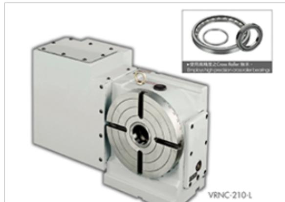
中国台湾电脑数控分度盘作为通用型机床附件比较常见（三）中国台湾分度盘的工作台主要由工作台、夹紧油缸及分度盘等零件组成，其中端面齿盘是关键部件，每个齿盘的端面均加工有相同数目的三角形齿，两个齿盘啮合时能自动确定周向和径向的相对位置。因此，端面齿加工水平的高低直接影响分度装置的精度，也终对整机的加工精度产生相当大的影响。分度盘端面齿的加工关键和重要。可以说，分度盘端面齿能确保加工中心CNC数控车床转塔刀架等多工序自动数控机床和其他分度设备的运行精度。操作前请确定完成选择钮定位；操作杆完成定位后，须将操作杆确实还原；如果分度头不会转动，则是选择钮操作有误，须转回原位重新操作；可立卧两用，分度较一般分度头更快速，适合铣床、钻床简易快速分割使用；操作过程只靠操作杆完成：程序为松夹、分度、定位、操作杆还原，其可一次完成；要分度时，只要轻转分度头周围的选择钮，就可配合选择钮定位，重复操作使用；选择钮凹槽向下为定位位置，凹槽向上跳跃位置。
